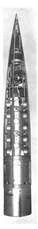
Das ist der Kopf einer "WAC-Corporal", die, als zweite Stufe von einer "A 4" startend, die Weltrekordhöhe von 412 km erreichte. Sie kann Instrumente im Gewicht von zirka 70 kg tragen
