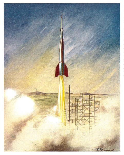
Eine Zweistufen-Rakete startet! Im erstenAbschnittdes Höhenfluges arbeitet nur das Triebwerk der ersten, unterenStufe, einer,, A4", im Augenblick der höchsten Geschwindigkeit löst sich die zweite Stufe, die,, WAC-Corporal", und fliegt mit eigenem Antriebweiter. Dahinter erkennt man noch deutlich  $das Montageger \ddot{u}st$
