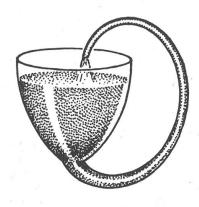
Abb. 2. Das Perpetuum mobile unter Zugrundelegung der Adhäsion
