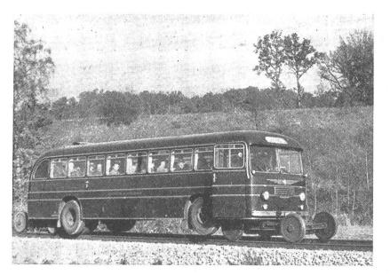
angehoben und dabei auf zwei zweiachsige Drehgestelle gesetzt (Abb. 2). Diese Drehgestelle führen das Fahrzeug im Gleis. Der Antrieb erfolgt durch den Fahrzeugmotor über die inneren Hinterreifen, deren antei-
