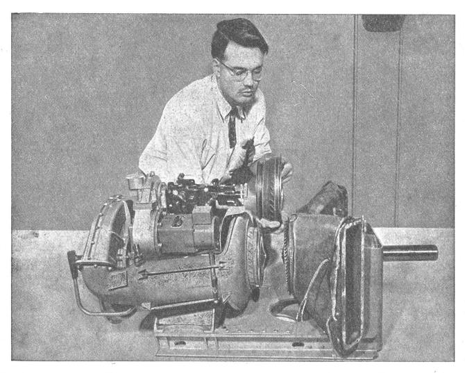
Das ist die Boeing-502-Doppelgasturbine für Lastkraftwagen. Der herausgenommene Teil ist die Düsenbüchse, welche die Aufgabe hat, die aus der Verdichterturbine (links, zusammen mit Luftkanal, Anlasser und Verdichter) ausströmenden Treibgase in die Nutzturbine (rechts, zusammen mit Auspuffleitungen und Abtriebswelle) hinüberzuleiten. Eine starre Verbindung von Verdichter- und Nutzturbine besteht nicht
