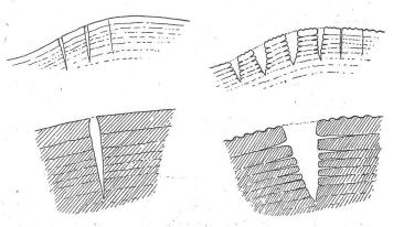
Abb. 1. Spalten und Schichten im Firn. Links in kühl-nassen Sommern, rechts in trocken-warmen Sommern
