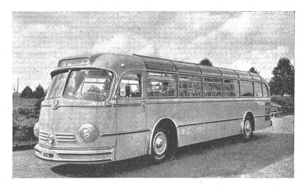
Der neue Mercedes-Benz-Großomnibus "O 6600 H" mit quer im Heck eingebautem 145 - PS - Sechszylinder-Dieselmotor und elektrisch geschaltetem Sechsgang-Getriebe unheimlich lang und raumfressend. Magirus, M.A.N. und Kaelble sind deshalb bei ihren neuen Schwerstlastern zum kurzbauenden "V-8" übergegangen. Noch radikaler hat Büssing das Unterbringungsproblem beim Dreiachs-Zwölftonner durch Unterflureinbaudes liegenden 180-PS-Sechszylinders gelöst.
