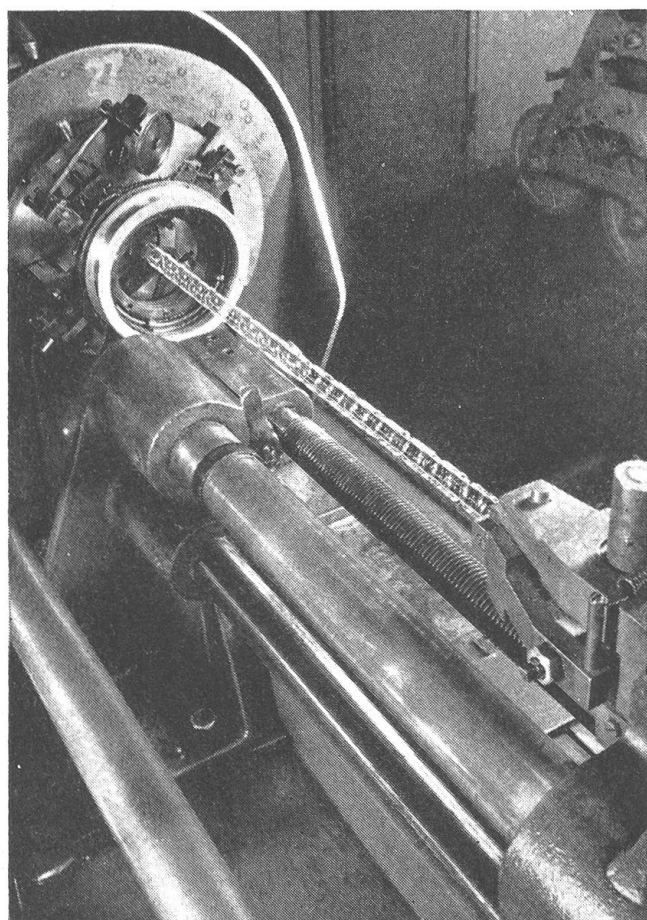
Abb. 5. Inzwischen werden auf dem Gitterwickelautomaten die Gitter der Radioröhre hergestellt. Mit höchster Präzision wirbelt die Maschine den haarfeinen Molybdändraht um die Haltestäbe. Später wird die ganze Länge in passende Stücke geschnitten
