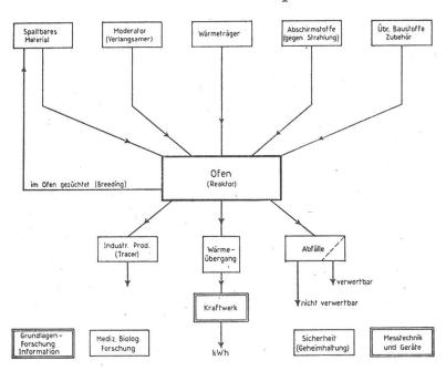
Abb. 7. Schema zur industriellen Anwendung der Kernenergie
