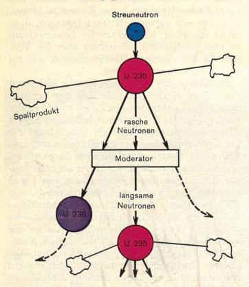
Abb. 2. Schema der Kettenreaktion mit Moderator
