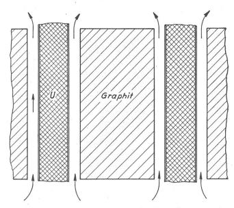
Abb. 9. Uranstab im Graphitreaktor
