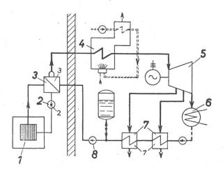
Abb. 10. Schema eines Schwerwasserreaktors mit Dampfkraftwerk
