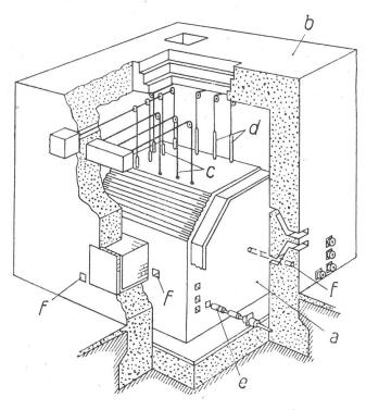
Abb. 4. Schematische Darstellung eines heterogenen Reaktors (Gleep) in Harwell (aus,,Nucleonics", 8, 4, 1951) d "Schnellschluß"-Stäbe a Uranstäbe und Graphit b Beton e Ionisationskammer
