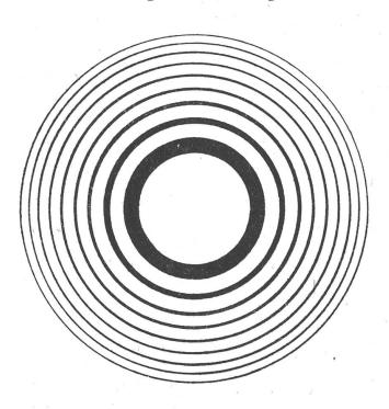
Abb. 1. Das Beugungsbild eines Sternes im Fernrohr (schematisch)
