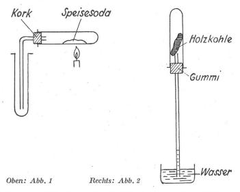
Dies geschieht in der durch Abb. 1 dargestellten Weise. In einer anderen — waagrecht gehaltenen, trockenen — Proberöhre wird etwas Speisesoda erhitzt, wodurch sich reichlich Kohlensäuregas bildet, welches in kurzer Zeit die lotrecht stehende Proberöhre füllt. Man kann sich davon überzeugen, indem man einen brennenden Span in die Proberöhre einführt. Er erlischt darin sofort, wenn er in das Kohlensäuregas eintaucht.
