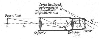
Abb. 4. Terrestrisches Fernrohr
