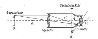
Abb. 3. Strahlengang beim astronomischen Fernrohr
