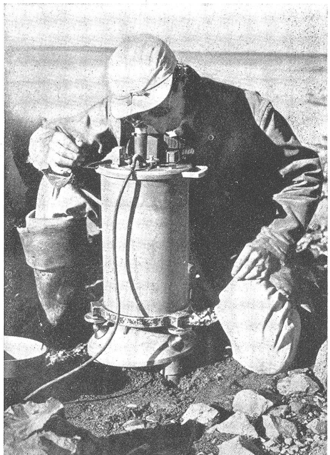
Abb. 1. Gravimeter im Feldebetrieb: Der Eisenmantel birgt den Thermostaten, das empfindliche Federmeßwerk und die photoelektrische Einrichtung, mit deren Hilfe Federdehnungen von einem Tausendstel bis zu einem Millionstel Millimeter am Galvanometer zum Ausdruck kommen
