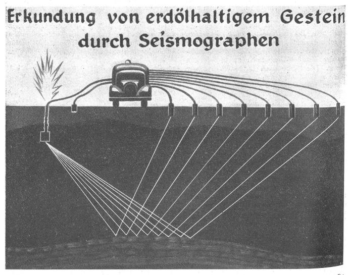
Abb. 3. Schematische Darstellung des Schallstrahlenverlaufes in einem reflexionsseismischen Meßprofil. Der Kraftwagen enthält den Mehrfachoszillographen nebst Zubehör, links davon die Explosionsstelle, rechts die oberflächlich eingegrabenen Geophone (Photo: Standard Oil Co., N. J. [3] und Verfasser [1])
