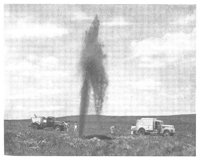
Abb. 4. Seismischer Meßtrupp im Gelände. Die explodierende Sprengladung, die das für die Messung nötige, künstliche und elastische Wellenfeld erzeugt, schleudert eine haushohe Erdfontäne empor
