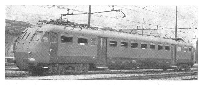
Abb. 19. Moderner Schnelltriebwagen der Italienischen Staatsbahnen aus dem Jahr 1949. Leistung 1000 PS, Maximalgeschwindigkeit 150 km pro Stunde
