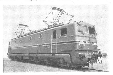
Abb. 15. Laufachslose Schnellzuglokomotive der Französischen Staatsbahnen aus dem Jahr 1946. Leistung 4800 PS, Maximalgeschwindigkeit 160 km pro Stunde
