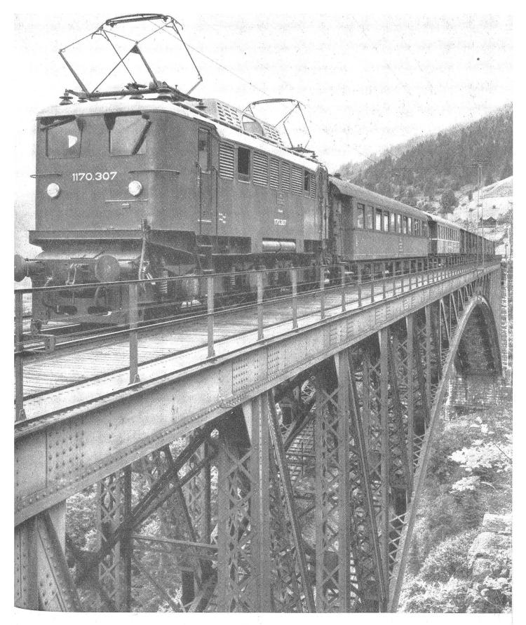
Abb. 18. Sowohl für die Personen- und Schnellzugsförderung, wie auch für den Güterdienst ist diese Universal-Elektrolokomotive verwendbar, die seit 1951 von den österreichischen Bundesbahnen verwendet wird und von der Firma Elin gebaut wurde. Gesamtleistung 3200 PS, Maximalgeschwindigkeit 90 km pro Stunde
