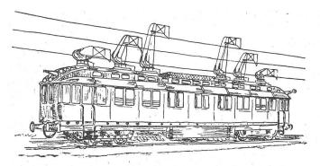
Abb. 7. Mit derartigen Schnelltriebwagen wurden in den Jahren 1901 bis 1903 Geschwindigkeiten bis zu 216 km pro Stunde erzielt
