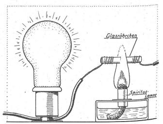
Glühlampe als ausreichender Widerstand in den Stromkreis eingeschaltet bleibt, kann kein "Kurzschluß" eintreten. Doch ist es besser, wenn Jugendliche dieses Starkstromexperiment nur unter der Aufsicht eines sachkundigen Erwachsenen durchführen. Ing. A. N.
