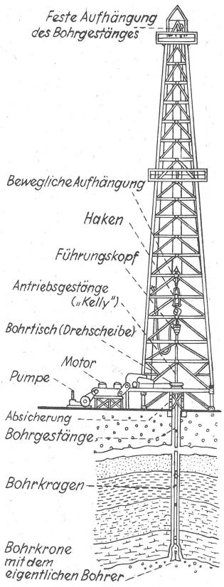
Schema eines Bohrturmes nach dem "Rotary"-Verfahren. Erdgas wird nach den gleichen Methoden erbohrt und gefördert wie Erdöl. Die tiefsten Erdgasfunde in der Po-Ebene liegen derzeit bei 3500 m
