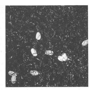
Mischgewebe Lanital-Wolle demMottenfraβ ausgesetzt. — Oben : Die Wollfasern dem Mischgewebe sind teilweise herausgefressen worden, während die Lanitalfasern fast unberührt zurückbleiben. Unten: Nach der Behandlung mit Mitin kann das Gewebe nicht mehr durch Mottenraupenzerstört werden
