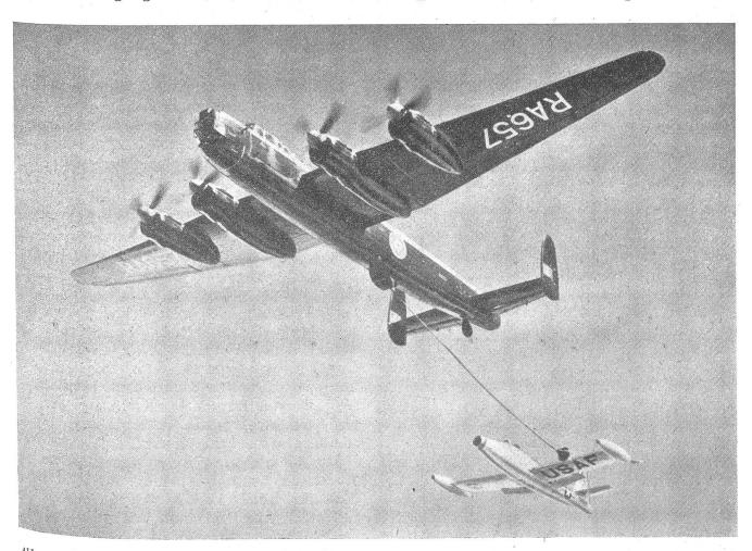
Abb. 3. Treibstoffübernahme im Fluge. Ein Thunderjet-Jagdflugzeug wird von einem Lincoln-Tankflugzeug mit Treibstoff versorgt. Hier tritt das "Trichtersystem" in Anwendung (The Illustrated London News)
