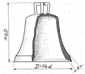
geformt, die in allen ihren Teilen, den Aufschriften und ornamentalen Ausschmückungen der echten entsprechen muß. Um diese "falsche Glocke" wird dann der Mantel gelegt, also die Außenform, die natürlich abhebbar ausgeführt sein muß. Sind also beide Formen hergestellt, so wird der Mantel abgehoben
