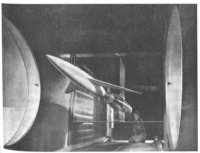
Abb. 2. In den aeronautischen Laboratorien und Forschungsanstalten in aller Welt beschäftigt man sich heute mit der Entwicklung von Raketen-Flugkörpern, die einmal als Weltraumschiffe konstruiert werden. Das Bild zeigt die Erprobung eines Modells im Überschall-Windkanal des Ames Aeronautical Laboratory in Moffet Field (USA.)
