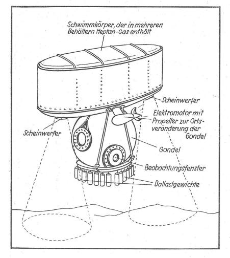
Abb. 5. Das Tieftauchgerät Prof. Piccards, mit dem er 1949 auf 4000 m Tiefe tauchen wollte. Nach langwierigen Manövern mußte er aber den Versuch aufgeben. Die Gondel des Gerätes wird von einem mit Heptangas gefüllten Schwimmkörper getragen. Im unteren Gondelrande sind Ballastgewicht angebracht, die auf elektromechanischem Wege abgeworfen werden können. Mit Hilfe kleiner Elektromotoren sollte eine gewisse eigene Beweglichkeit der Gondel erreicht werden
