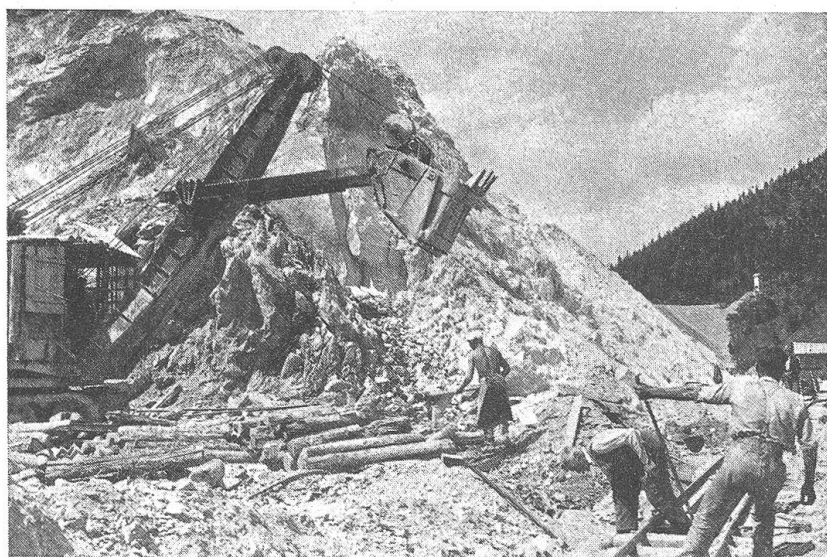
Abb. 2. Die im Tagbau gewonnenen Rohmagnesite werden mit Baggermaschinen auf eine Materialbahn verladen und zur Seilbahn befördert, die über 7,5 km den Bruch mit dem Werk Radenthein verbindet
