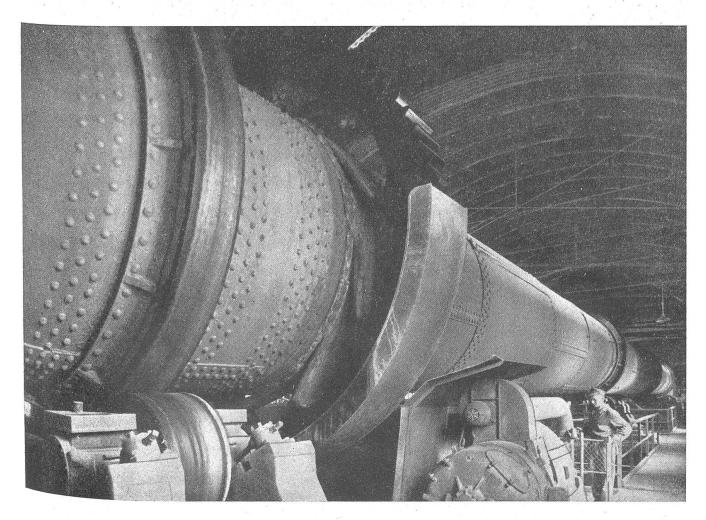
Abb. 4. Ansicht eines Drehrohrofens, in dem das Brennen des Rohmagnesits erfolgt
