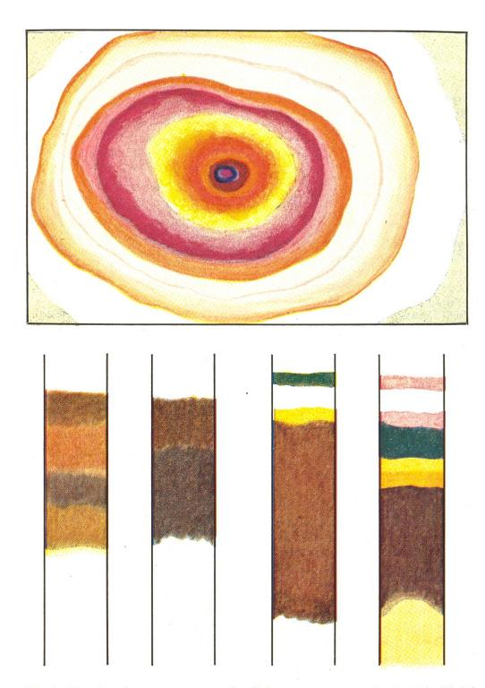
Abb. 4. Oben Ringchromatogramm von käuflichem Eosin, entwickelt mit 90% Alkohol. Links Untersuchung von Perubalsam. Der echte Balsam zeigt vier braune Zonen im Chromatogramm, der synthetische dagegen nur zwei. Rechts Chromatogramm von Alpenbutter, gelöst in Benzol. Im Tageslicht lassen sich nur vier Zonen unterscheiden, im Ultraviolett dagegen sieben
