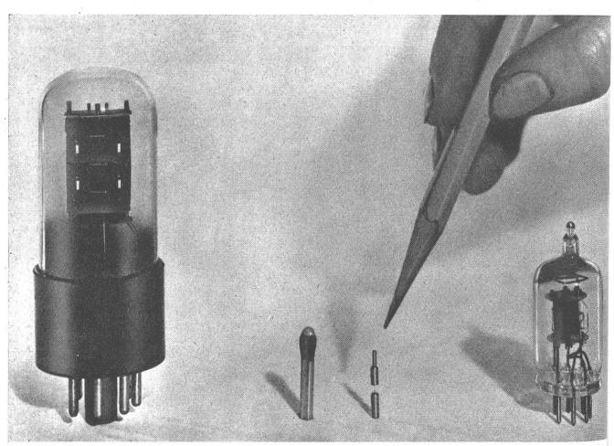
In Amerika wurde diese neue, für Fluggeräte bestimmte Miniaturradioröhre entwickelt, die nur ein Neunzehntel Mormalgröße der üblichen Röhren besitzt. Abgesehen von dem Vorteil der Raum- und Gewichtsersparnis soll diese Röhren auch gegen die von den Motoren verursachten Erschütterungen sowie gegen die Stöße beim Aufself des Flugzeuges bei der Landung wesentlich widerstandsfähiger sein. Zum Vergleich der Größenverhältnisse: Lind und rechts von der neuen Röhre zwei Normalröhren und ein Zündholzkopf
