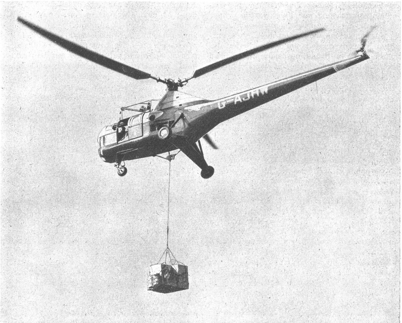
Transport von Gütern durch einen mit einer Spezialvorrichtung zum Heben von Lasten ausgerüsteten Westland-Sikorsky S-51-Helikopter
