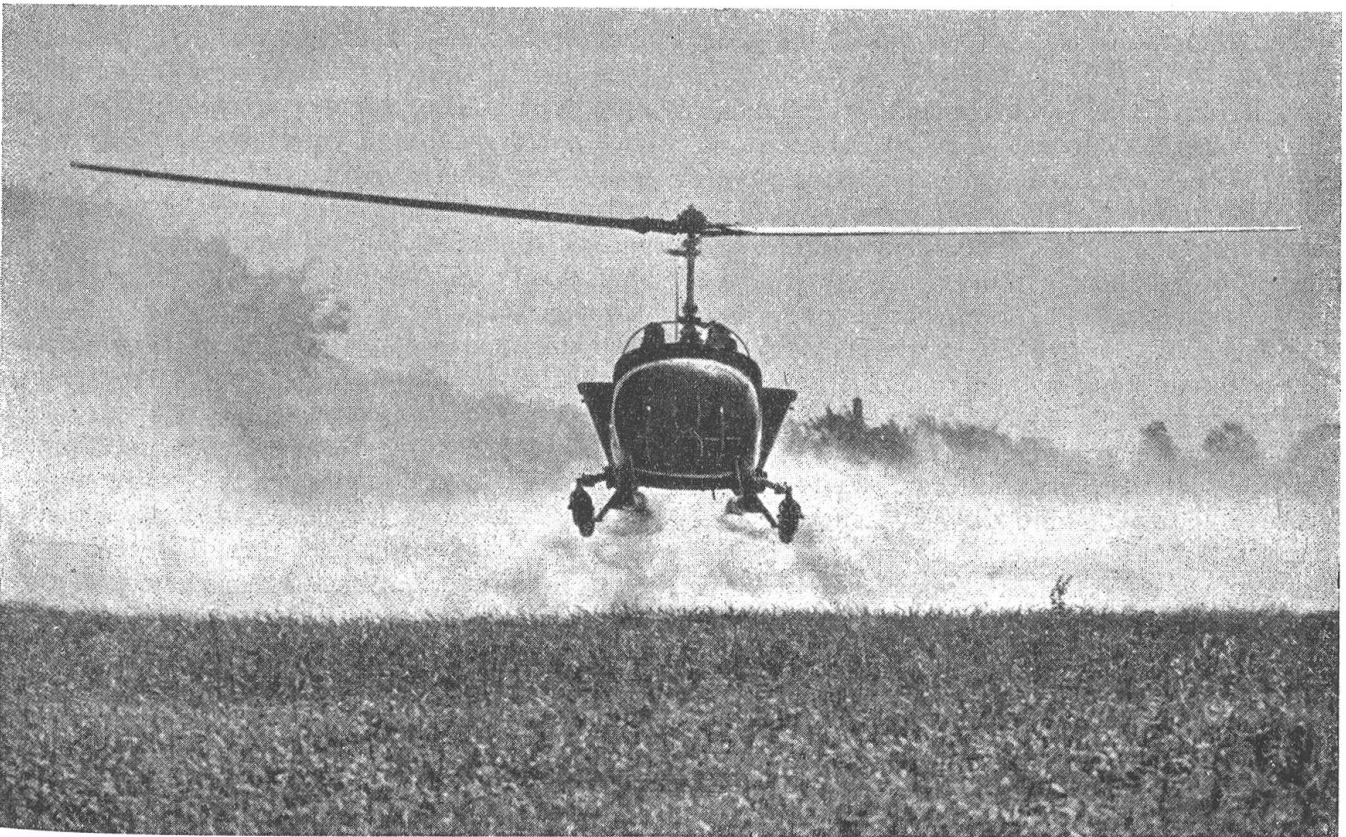
Ein Hubschrauber vom verbesserten Typ 47-C der Aircraft Comp. bei der Schädlingsbekämpfung, wozu sich Hubschrauber besser als jeder andere Flugzeugtyp eignen, weil der von den Windmühlenflügeln erzeugte Abwind das pulverige Schädlingsbekämpfungsmittel nach unten drückt
