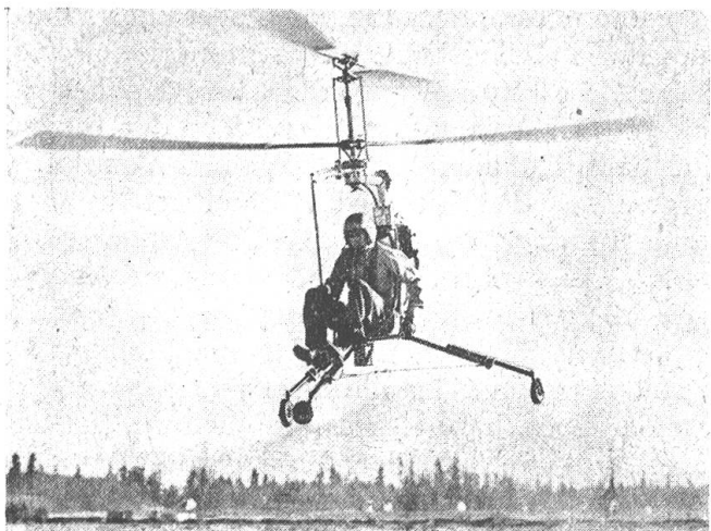
Der Hoppi-Copter als Anschnallgerät, das ein Gewicht von etwa 40 kg hat
