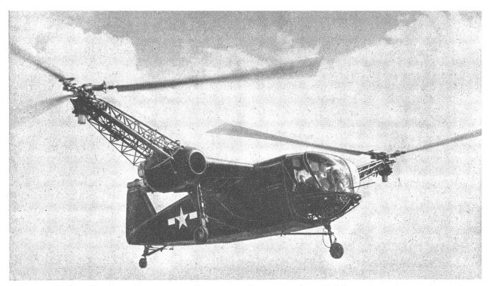
Dieses von der MacDonnell Aircraft Corporation herausgebrachte Modell verfügt über zwei in gleicher Höhe angebrachte Hubschrauben, die von Zwillingsmotoren angetrieben werden
