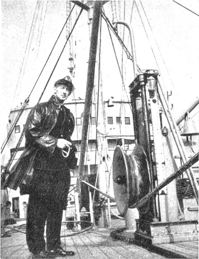
Abb. 5. Das neu zu verlegende Kabel läuft unter Aufsicht eines Deckoffiziers ab. Die Skala im Vordergrund zeigt die Spannung in cwt (hundred-weights) an, während das Gewicht pro Meile etwa 10 Tonnen ausmacht
