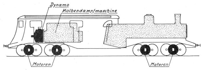
Abb. 2. Die erste dampfelektrische Lokomotive System Heilmann (1900)
