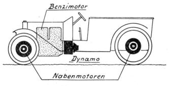
Abb. 3. Schema eines Kraftfahrzeugs nach dem System "Electro-mixte" (um 1905)
