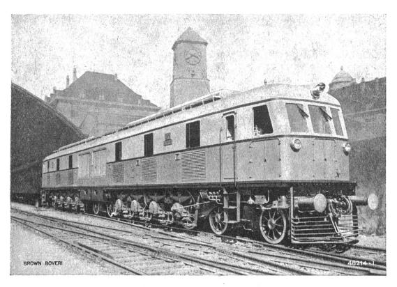
Abb. 8. 4400 PS dieselelektrische Lokomotive der Rumänischen Staatsbahn (erbaut von Brown - Boveri & Cie., Baden)
