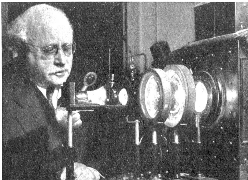
Abb. 1. Prof. Ehrenhaft, der Entdecker der Photophorese, bei Versuchen mit künstlichen Lichtquellen im Physikalischen Institut in Wien. Prof. Ehrenhaft beobachtet eine Kreisbahn mit der Lupe. Rechts im Bilde die beiden Linsen, die den Lichtstrahl konzentrieren
