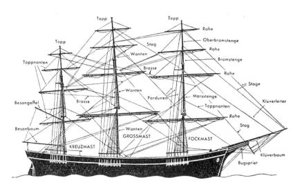
Abb. 4. Takelung eines Vollschiffes
