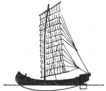
Abb. 7. Chinesische Fluß-dschunke. Ein Mast mit sehr hohem, vielfach unterteiltem Segel. Das Kürzen erfolgt durch Herablassen
