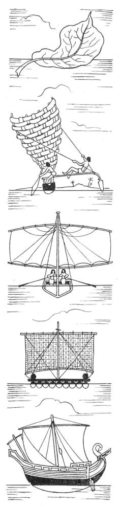
bessere Ausnützung von Querwinden ermöglichten. Die ganz vorne unter dem Bugspriet geführten, ziemlich unwirksamen Quersegel werden ebenfalls durch dreieckige Segel (Klüver) verdrängt, die längs Tauen mastwärts aufgezogen werden. Später finden sich auch zwischen den Masten ganz gleichartige sogenannte Stagsegel. Der letzte Mast trägt dann ein mitunter zweiteiliges Gaffelsegel, die sogenannten Besan, mit einem dreieckigen Toppsegel an der Mastverlängerung darüber.
