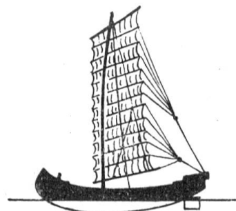
Abb. 7. Chinesische Flußdschunke. Ein Mast mit sehr hohem, vielfach unterteiltem Segel. Das Kürzen erfolgt durch Herablassen
