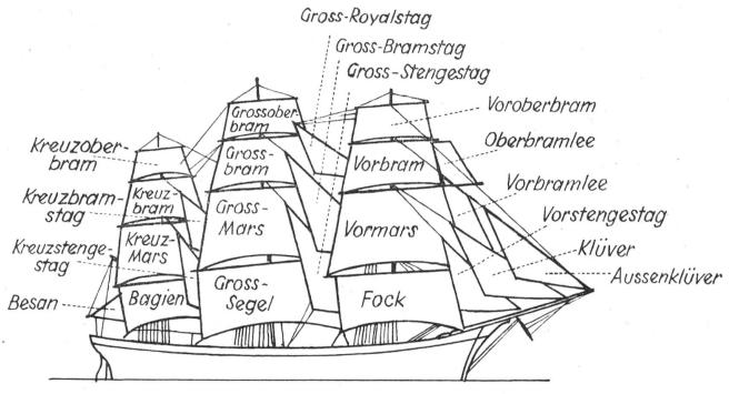
Abb. 5. Segelriß eines Vollschiffes
