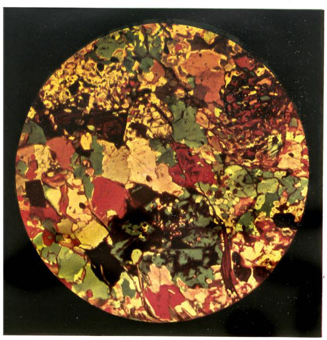
Abb. 16: Glimmerschiefer aus dem Erzgebirge, quer zur Schieferung geschliffen und in polarisiertem Licht photographiert
