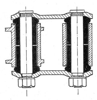
Abb. 5: Eine neue, gummigelagerte Federaufhängung für einen Kraftwagen
