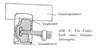
sätzliche Federung. Die Endblätter der Feder werden nach oben und unten hin elastisch gehalten. Da die Kräfte nach oben hin größer sind, muß dort der Gummikörper stärker gehalten sein. Diese Form läßt auch die nötige Längsbeweglichkeit zu.
