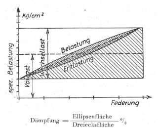
Abb. 1: Die "Dämpfung" ist eine wichtige Kennziffer der Gummiart
