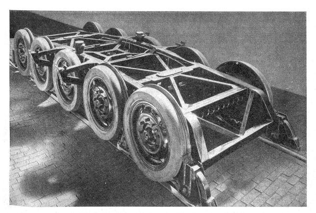
Abb. 3: Das Drehgestell der neuen Schnellzugwagen der CNCF
