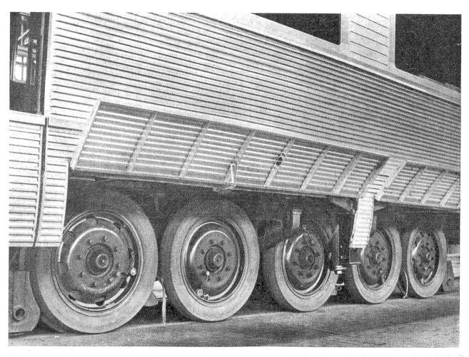
Abb. 2: Schnellzugwagen auf gummibereiften Rädern
