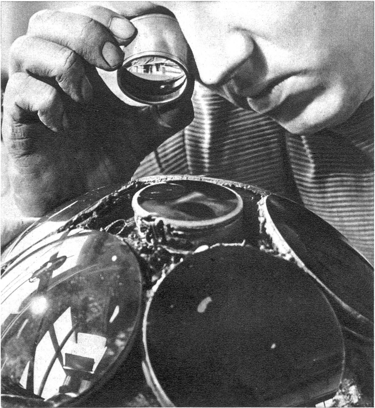
Abb. 9: Prüfung des Bearbeitungszustandes von Linsen auf dem Polierkopf
