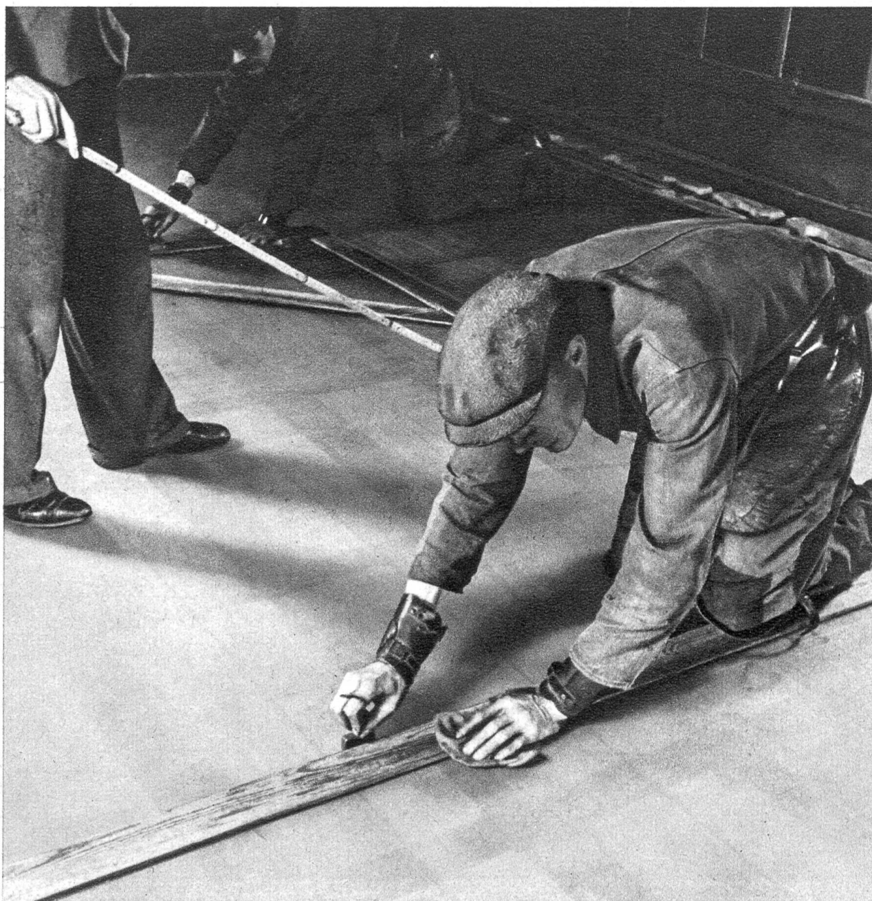
Abb. 4: Gehärtete Stahlrädchen werden an Linealen entlanggeführt und schneiden aus der großen Glastafel die gewünschten Stückgrößen heraus
