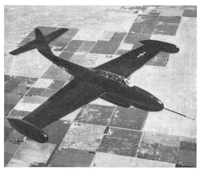
Bild 2: Der Düsenjäger der amerikanischen Luftwaffe, Northrop XF-89. Es ist der erste «Zweisitzer» dieser Art und kann als solcher Pilot und Radarbetreuer mitnehmen. Die Länge und die Flügelspannweite betragen rund 15 Meter, die Höhe 4 Meter 50. Der Jäger ist mit Schleudersitzen ausgestattet, da bei diesen Geschwindigkeiten ein Aussteigen und Abspringen im Notfall nicht mehr möglich ist.
