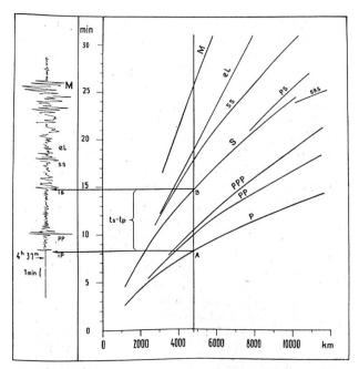
Abb. 2: Seismogramm eines Fernbebens (links); Laufzeitdiagramm (rechts).
