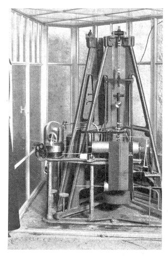
Abb. 4: Seismograph nach Mainka mit zwei Horizontalpendeln.
