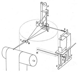
Abb. 5: Hebelübertragung und Luftdämpfung eines Horizontalpendels (Mainka)
