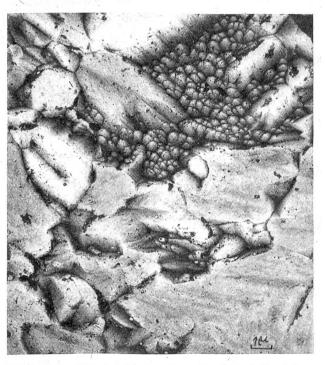
Bild 8: Gefügebild einer Hydronalium-Oberfläche (Aluminium-Magnesium-Legierung) (Lack-Abdruck, Vergrößerung 4500:1) Sämtliche Aufnahmen vom Verfasser.
