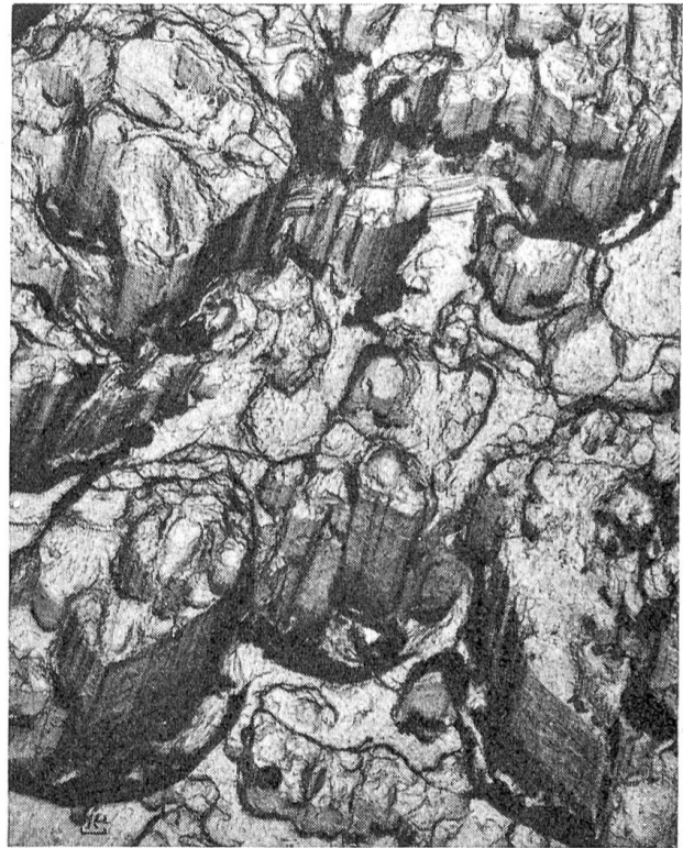
Bild 6: Präge-Abdruck von der Bruchfläche eines Stahlstiftes. Die Struktur der Bruchfläche gibt einen Einblick in die Gefügestruktur des Stahls, der in diesem Beispiel aus parallel gelagerten stäbchenförmigen Kristalliten besteht. (Vergrößerung 2500:1)
