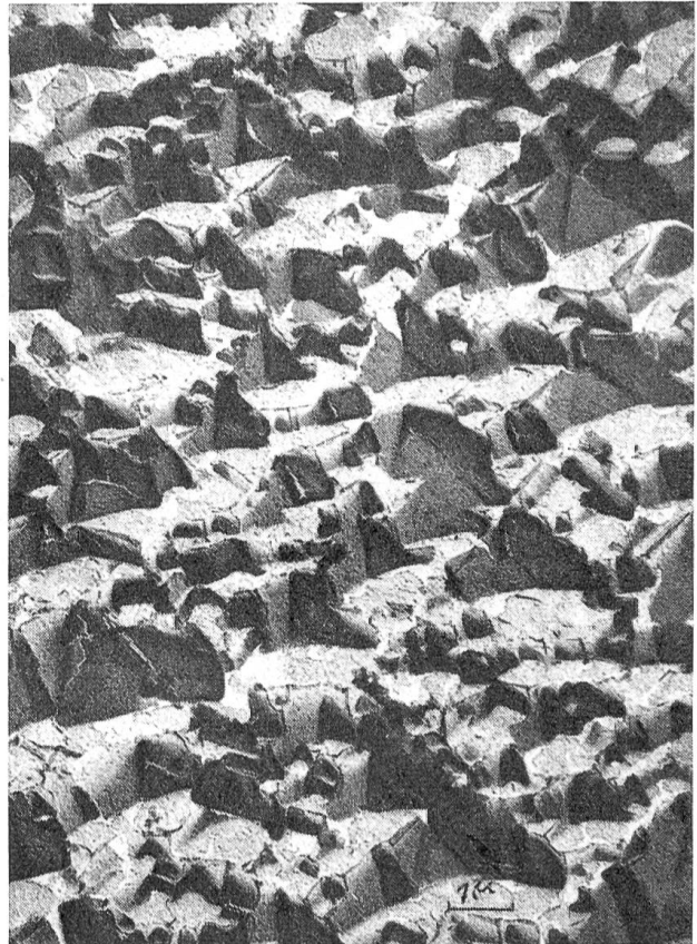
Bild 2: Ätzfiguren bei Steinsalz, aufgenommen mit einer Aluminium-Aufdampfschicht. Eine polierte Steinsalz-Oktaederfläche wurde angehaucht. Die dabei auftretende Anlösung des Steinsalzes führte zu einer Freilegung von Würfelflächen des Kristalls. (Vergrößerung 7000:1)
