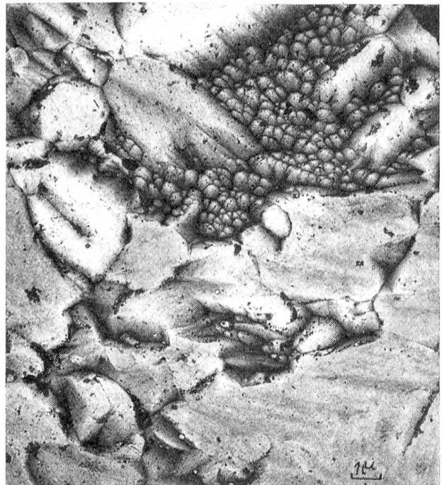
Bild 8: Gefügebild einer Hydronalium-Oberfläche (Aluminium-Magnesium-Legierung) (Lack-Abdruck, Vergrößerung 4500:1)
