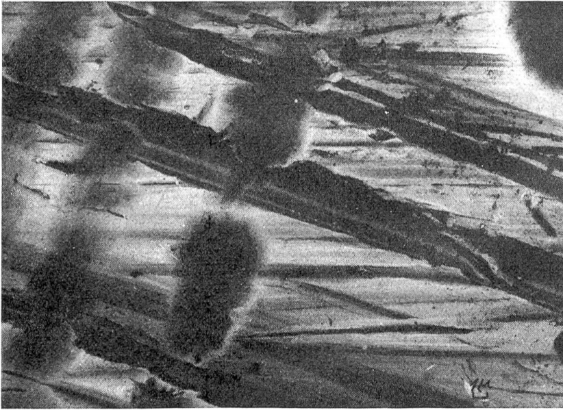
Bild 7: Oberfläche eines feingeschliffenen Stahls, aufgenommen mit einem Lack-Abdruck. Es ist eine Stelle wiedergegeben, die vorher mit einem mechanischen Rauigkeits-Prüfgerät abgetastet worden war. Die großen Abtastspuren, die als dunkle Flecken zu sehen sind, beweisen, daß die eigentliche Mikrostruktur der Oberfläche durch die Abtastung nicht erfaßt wird. (Vergrößerung 2500:1)
