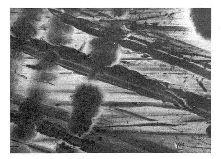
Bild 7: Oberfläche eines feingeschliffenen Stahls, aufgenommen mit einem Lack-Abdruck. Es ist eine Stelle wiedergegeben, die vorher mit einem mechanischen Rauhigkeits-Prüfgerät abgetastet worden war. Die großen Abtastspuren, die als dunkle Flecken zu sehen sind, beweisen, daß die eigentliche Mikrostruktur der Oberfläche durch die Abtastung nicht erfaßt wird. (Vergrößerung 2500:1)
