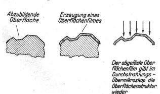
Bild 1: Schematische Darstellung des Abdruck-Verfahrens zur elektronenmikroskopischen Oberflächen-Abbildung.
