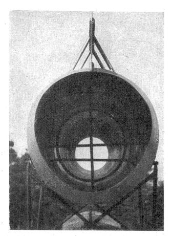
Blick in ein Staustrahlrohr von 1,5 m Durchmesser
