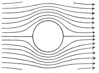
Fig. 1. Laminare Strömung um eine Kugel
