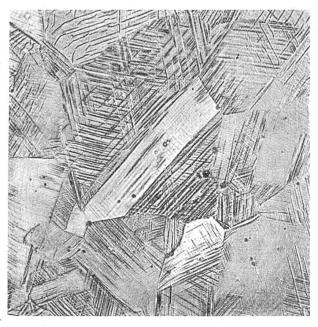
Netzwerk von Gleitlinien in einem abgeschreckten Mangan-Hartstahl. Die regelmäßige Orientierung des Liniensystems in den einzelnen Kristallen ist gut zu erkennen (etwa fünfhundertfach vergrößert)
