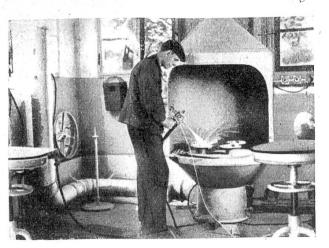
Spritzverzinken. Die Haube über dem drehbaren Spritztisch fängt die Metallüberschüsse auf und leitet in Verbindung mit einem Exhaustor die Schadstoffe ab
