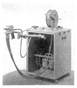
Eine startbereite Metallspritzmaschine
