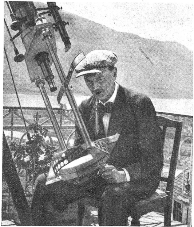
Bild 9: Projektionstisch mit Beobachter. In der Praxis wird unter einem schwarzen Tuch gearbeitet. Auf einem weißen Blatt Papier sieht man die Sonne mit 25 cm Durchmesser und auf ihr alle Flecken und Randfackeln in großer Präzision. Die Gebilde werden täglich nachgezeichnet nach Lage und Form. Solche Zeichnungen bilden die Unterlage für die Sonnenstatistik der Eidgenössischen Sternwarte, die gleichzeitig internationale Zentralstelle für Sonnenforschung ist
