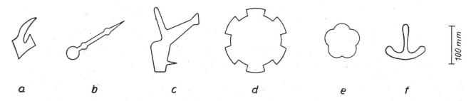
Arbeitsbeispiele in Stahl, von 40 mm gesägter "Konturen", Arbeitszeiten: a) 16 Minuten, b) 20 Minuten, c) 45 Minuten, d) 110 Minuten, e) 25 Minuten, f) 28 Minuten
