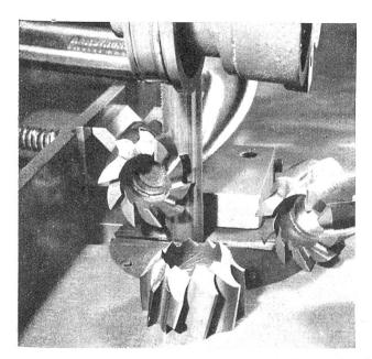
Das Schneiden ausgebrochener gehärteter Fräser. Die defekten Zähne werden in 23 Sekunden bei einer Schnittgeschwindigkeit von 5000 Meter je Minute abgesägt
