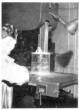
Die Säge ist wegen der versprühenden Stahlfunken mit einem Schutzzylinder aus Plexiglas umgeben
