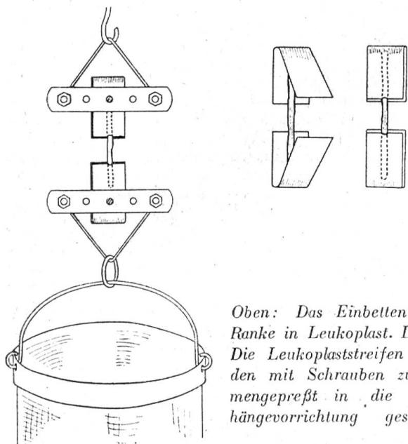
Oben: Das Einbetten der Ranke in Leukoplast. Links: Die Leukoplaststreifen werden mit Schrauben zusammengepreßt in die Aufhängevorrichtung gespannt
