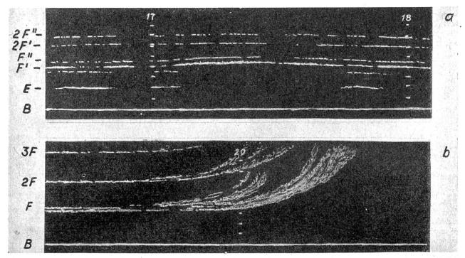
Ausschnitte aus Registrierstreifen. B Bodenwelle, E E-Schicht, F' Reflexion an der F-Schicht, F' Reflexion an einer darüberliegenden Schicht, 2F zweifache Reflexion an der F-Schicht. — Die untere Abbildung b zeigt die Streuung vor dem abendlichen Aussetzen oder dem morgendlichen Einsetzen der Reflexion
