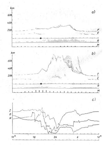
Reflexion an der Ionosphäre. a) ungestört, b) starke Störung, c) gleichzeitige erdmagnetische Komponenten während der Störung
