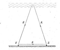
Zenitlotung der Ionosphäre. S Sender, E Empfänger, B Bodenwelle, R Raumwelle
