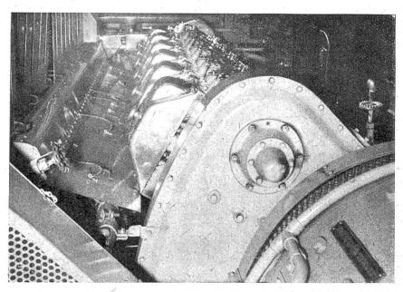
Eine Seite einer 12-Zylinder-Zweitakt-Diesel-Maschine, die den Generator in Bewegung setzt, der die elektrische Energie zum Antrieb der Motoren liefert
