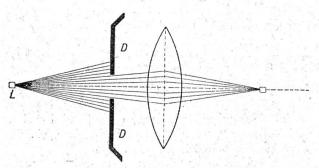
(Abb. 3) Abblenden der Randstrahlen zur Beseitigung der sphärischen Abberation
