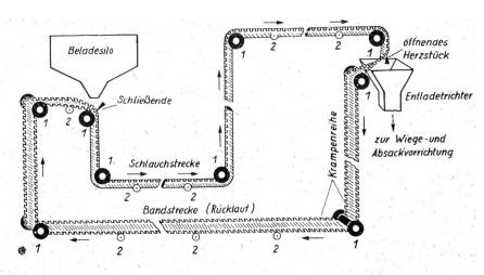
so daß der Schlauch wieder zum Bande wird und das darin herangeschaffte Gut in einen Trichter, ein Silo, oder eine Absackvorrichtung geben kann.
