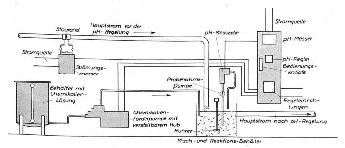
Prinzip einer Anlage zur automatischen pH-Regelung
