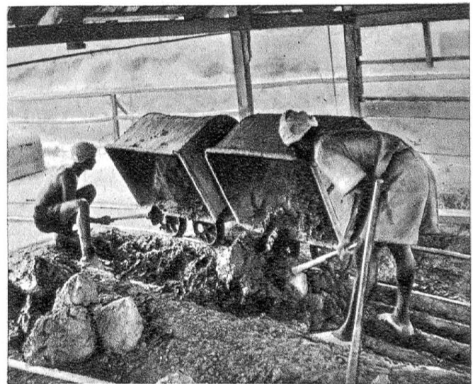
Oben: Das geförderte Gut wird aus den Loren gekippt und den Mahlanlagen zugeführt
