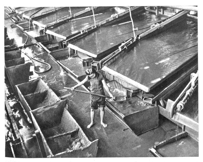
Auf diesen Tischen werden aus dem mit Wasser versetzten Mahlgut der Sand und die leichteren Fremderze herausgeschwenmt und von chinesischen Arbeiterinnen abgeschöpft; das schwere Zinn setzt sich am Boden ab
