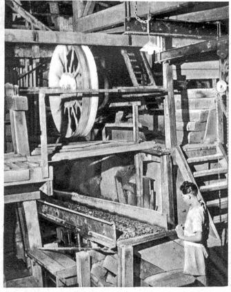
Dieses Sieb sortiert allzu große Brocken aus und schickt sie zum Brecher zurück; das feinere Gut gelangt in die Mahlanlage
