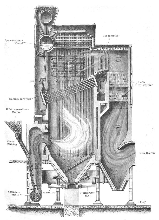
Abb. 3: Gesamtanlage eines Dampfkessels mit Krämer-Mühlen-Feuerung für Braunkohlen-Betrieb
