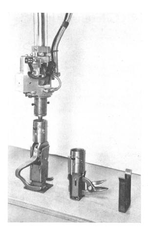
Druckes auf das Pedal zwischen den Haken der Hand einen Gegenstand mit viel größerer Kraft zu pressen – also etwa einen Maschinenteil festzuhalten – als selbst der stärkste Mann mit seinen Fingern drücken kann. Aber ein ganz gelinder Druck auf das Pedal überträgt einen entsprechend feinen Druck zwischen den Haken, und es ist zum Beispiel möglich, mit den Kunsthänden die Schale eines hartgekochten Eies aufzubrechen, ohne das Ei selbst zu beschädigen.
