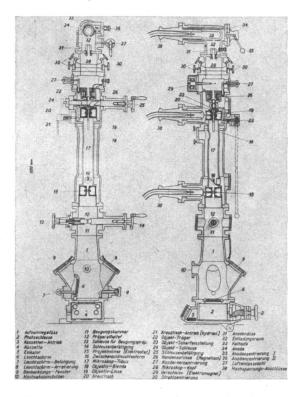
Bild 2: Zwei Längsschnitte durch das schweizerische Elektronenmikroskop.
