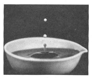
Bild 1: Ein Tropfen Milch fällt in Kaffee. Man beachte die mit der Kamera (1/500 Sekunde) festgehaltenen komplizierten Vorgänge, welche der Mischung vorausgehen. (Aufnahme des Verfassers)
