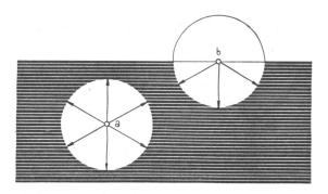
Bild 2: Die verschiedenen molekularen Kohäsionskräfte, die auf ein Teilchen im Innern (a) und an der Oberfläche (b) einer Flüssigkeit wirken.
